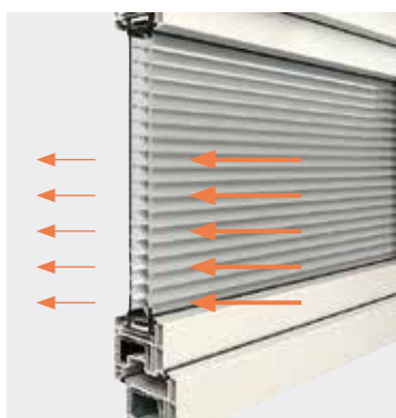
Tussen de ruiten geplaatste zonwering kan de warmtestraling van de zon slechts met 10 tot 15 % reduceren.
